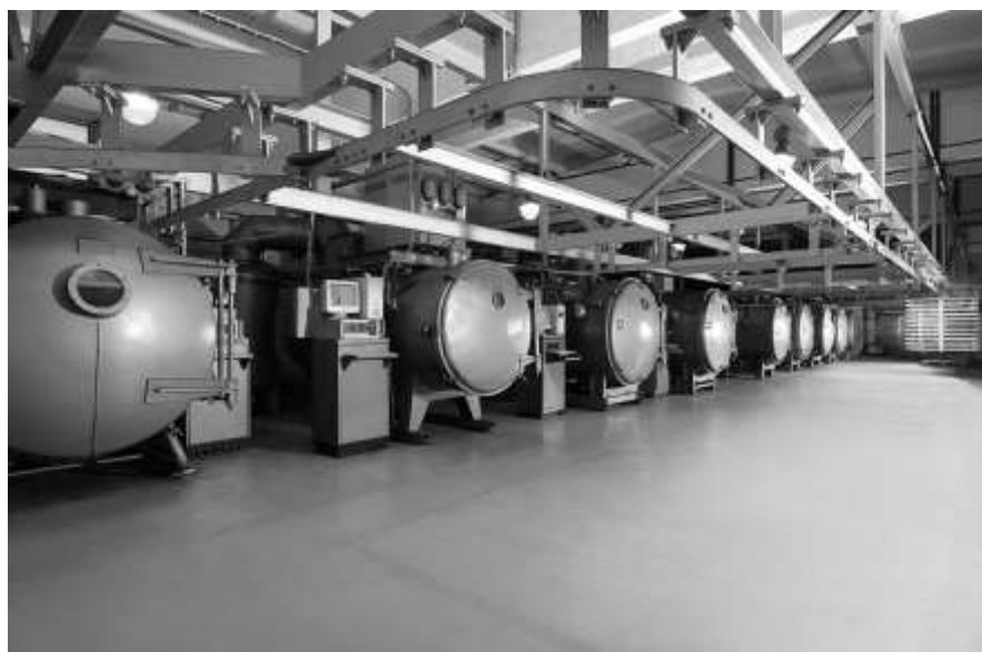
Рис. 14.8. Промышленная линия сублимационной сушки по производству продуктов питания ТД «Мазурин» (РФ). К началу 2017 года в ассортименте компании насчитывалось более 60-ти видов продуктов сублимационной сушки собственного производства.
