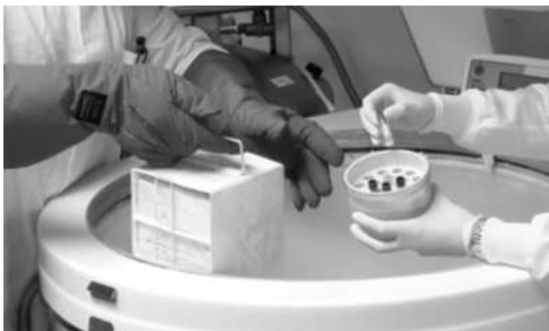
Рис. 29.4. Замораживание стволовых клеток. Перемещение образцов, замороженных со скоростью 1 град/мин, из изопропилового контейнера в хранилище с жидким азотом.
