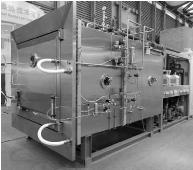
Рис. 14.7. Общий вид сублимационных установок для предприятий медицинской и микробиологической промышленности.
