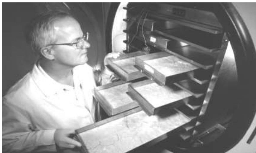
Рис. 14.3. Пример размещения сублимируемого материала на полках.
