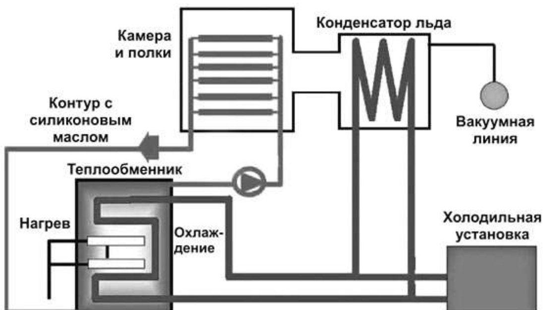
Рис. 14.5. Принципиальная схема установки для сублимационной сушки биологического сырья. Объяснение в тексте.
