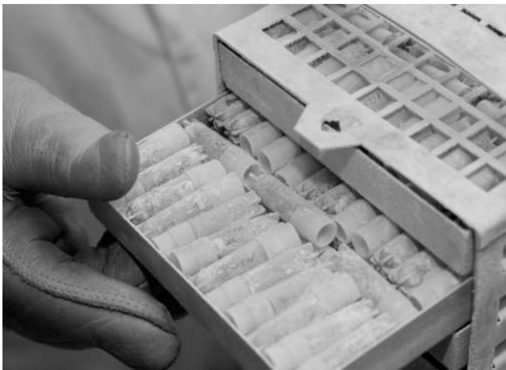
Рис. 15.15. Металлический штатив с криопробирками. В криопробирках находится замороженный биологический материал; штативы с пробирками хранятся в криохранилище, заполненном жидким азотом.
