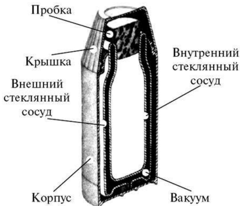
Рис. 15.9. Термос - разновидность сосуда Дьюара ( http://bergner.ua/blog/18/ )
